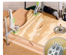
76 Fräsen nach Schablonen mit Kugellager und Kopierhülse
