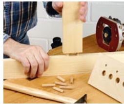
144 Runddübel mit der Oberfräse einbohren – die Dübelschablone
